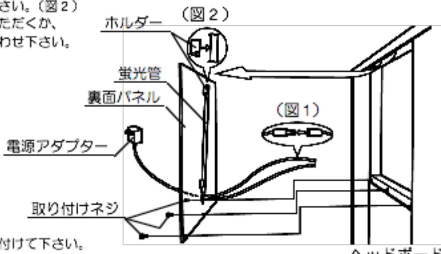
⑥取り外しと逆の作業で新しい蛍光管を取り付けて下さい。
